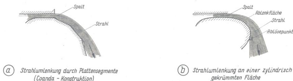
Abbildung 1.1: Strahlumlenkung (Clark 1959)
