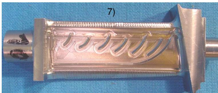
**Abbildung 6.4: Teilbearbeitung des Grundkörpers**
