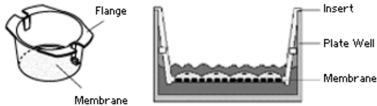
Abb. 3.6. Aufbau der modifizierten Boydenkammer (von BD Biosciences)
