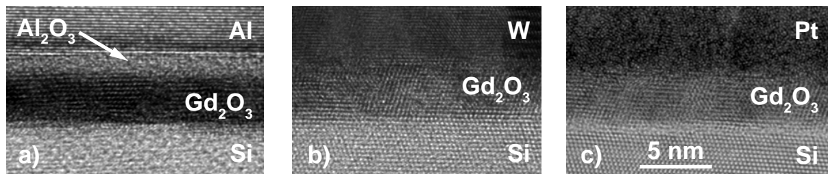
Abb. 7.1: TEM-Querschnitt von MIS-Strukturen mit verschiedenen Metall-Gates. Al reduziert \text{Gd}_2\text{O}_3 und bildet eine \text{Al}_2\text{O}_3 -Zwischenschicht. W- und Pt-Elektroden sind im Kontakt mit \text{Gd}_2\text{O}_3 stabil.
