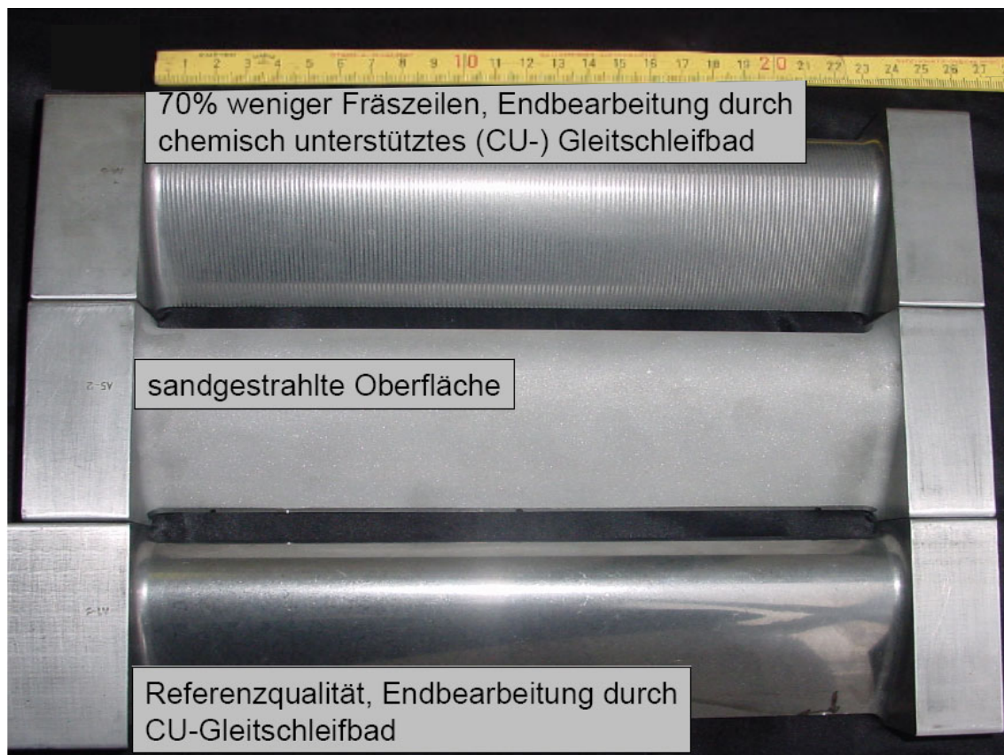
Bild 4-1.1: Beispiele typischer Oberflächenstrukturen Gitter AGTII-S
