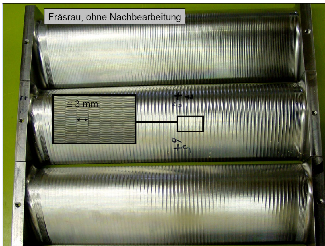
Bild 4-1.2: Beispiele typischer Oberflächenstrukturen Gitter AGTII-A
