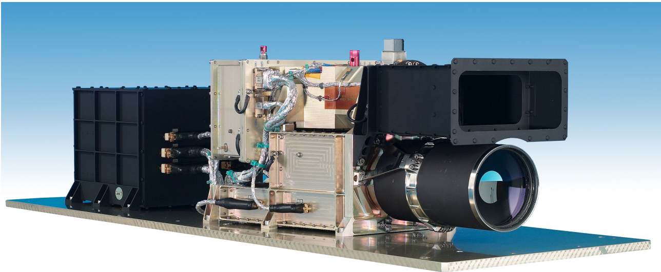
Abb. 10: HRSC FM2 für Mars Express, Quelle: DLR
