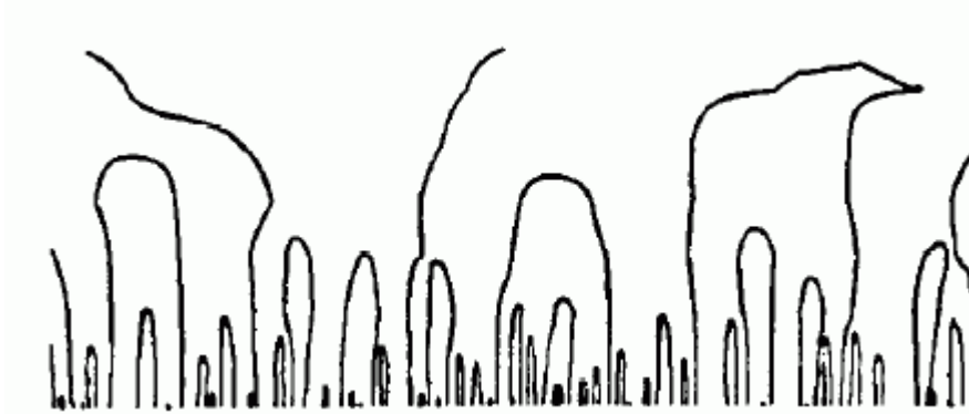
Abb. 18: Position der Kanten (Nulldurchgänge des Laplace-Filters) entlang des linearen Skalenraums, Quelle: (Witkin 1983)
