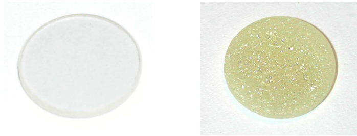
Abb. 7.15: ZnS-Kristall vor (links) und nach (rechts) der Reaktion
