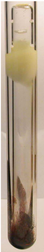
Abb. 7.16: Ampulle nach der Reaktion - mit Selen-Bodenkörper, ZnS_xSe_{1-x} -Partikelfilm (gelber Feststoff in Ampullenmitte) und Kristall (auf dem Stempel)
