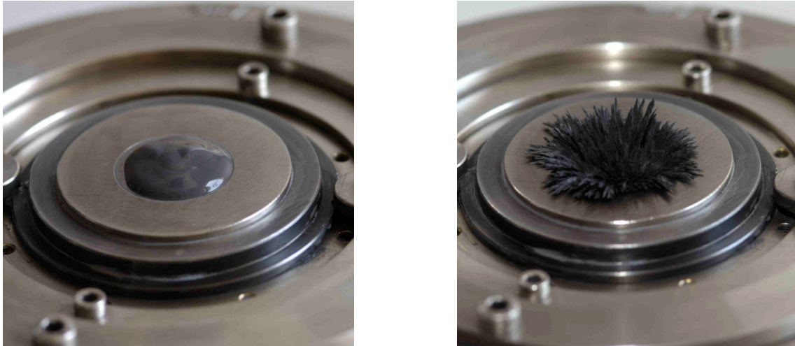
Abb. MRF 1.2: links: MRF ohne Einfluss eines Magnetfeldes; rechts: MRF bei angelegtem Magnetfeld [1]
