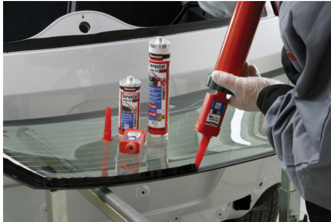
Abb. EPO 1.3: Direktverglasung der Karosserie mittels Klebstoffen auf Polyurethan-Basis [54]
