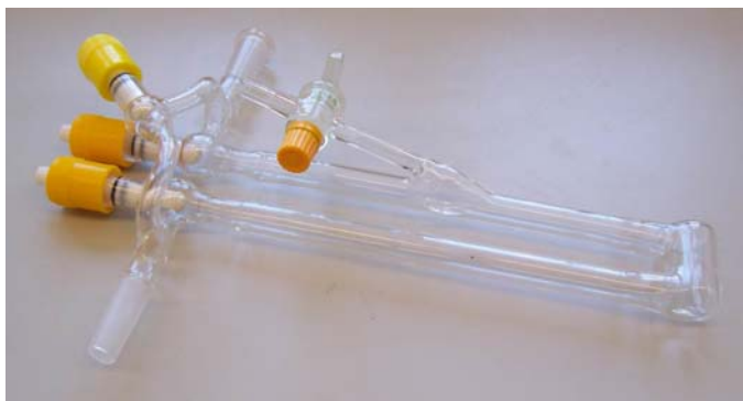
Abbildung 3.1: Kühlfalle zum Auffangen der Reaktionsprodukte.
