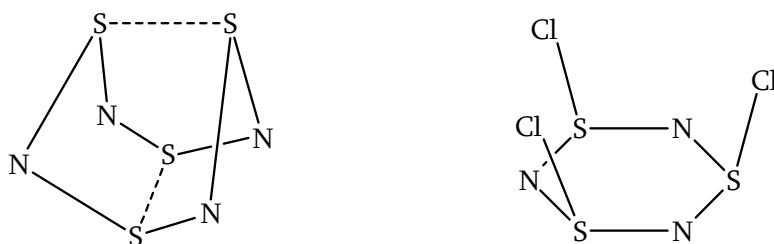
Abbildung 8.16: Räumliche Darstellungen der Verbindungen S_4N_4 (links) und S_3N_3Cl_3 (rechts)
