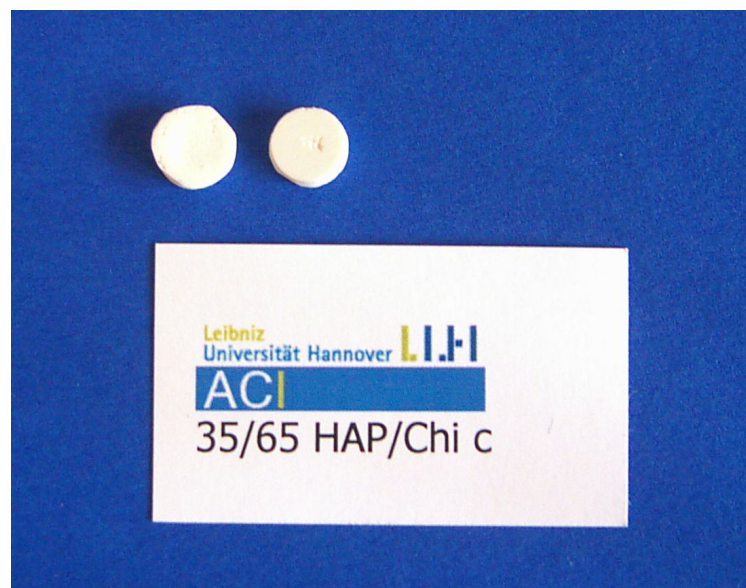
Abb. 6-1. Photographie eines Chitosan-Hydroxylapatit-Komposits mit einem Chitosan/Hydroxylapatit-Verhältnis von 65/35. Das verwandte Chitosan war hochviskos. Der Durchmesser der Komposite beträgt circa 6 mm.
