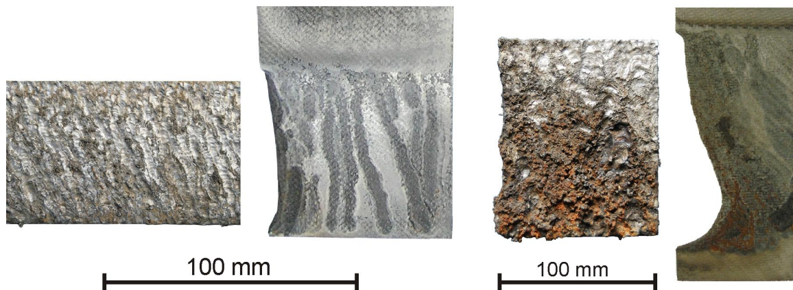
Bild 5.23: CAMC-Schnittfugenflächen und –Elektroden bei starker Spülströmung (links) und bei schwacher Spülströmung (rechts)
