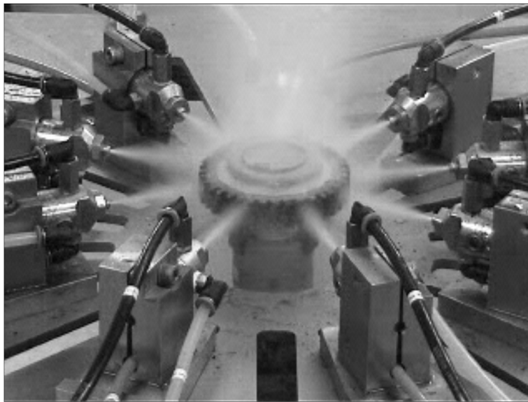
Abbildung 43: Abkühlung eines präzisionsgeschmiedeten Zahnrades im Sprayfeld durch ein Zweiphasenspray [Käs05, Kra08]
