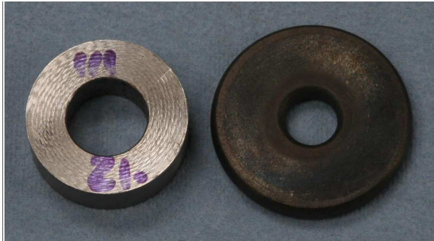
Abbildung 3-1: Probenkörper vor (links) und nach (rechts) einem Ringstauchversuch.
