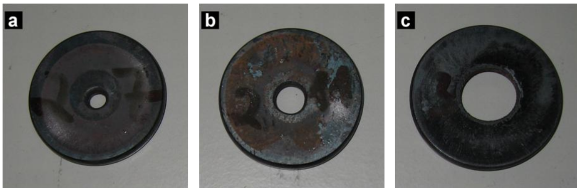
Abbildung 5-56: Photographische Aufnahmen der Probenkörper nach dem Ringstauchversuch: a) ohne Schmierstoff, b) mit CMK-3 als Schmierstoff und c) mit kommerziellem Schmierstoff.
