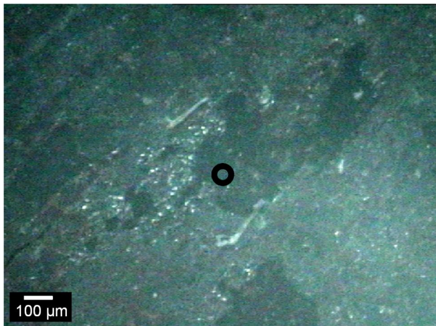
Abbildung 5-58: Lichtmikroskopische Aufnahme der Oberfläche einer Probe nach dem Ringstauchversuch mit Kompositmaterial als Schmierstoff (schwarzer Kreis = durch \mu -RFA-Messung untersuchte Stelle).
