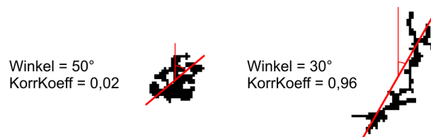
Abbildung 27: Zwei Beispielobjekte mit Angaben zu ihrer Ausrichtung, beschrieben durch Winkel und Korrelationskoeffizient
