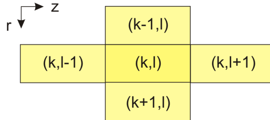
Abb. A.3: Indizierung benachbarter Bilanzvolumina im Rechengitter
