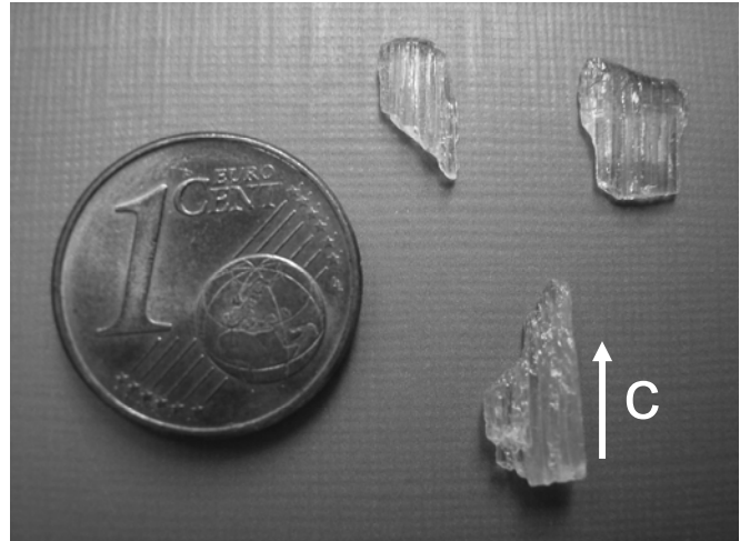
Abbildung 4: Schmelzmullite mit charakteristischer Streifung
