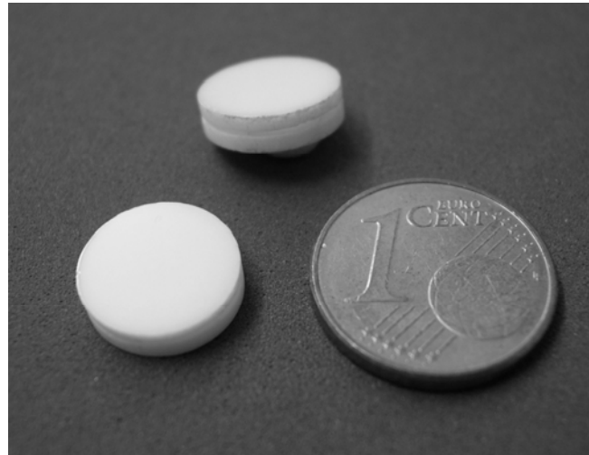
Abbildung 3: 3/2-Mullitkeramiken mit Nut
