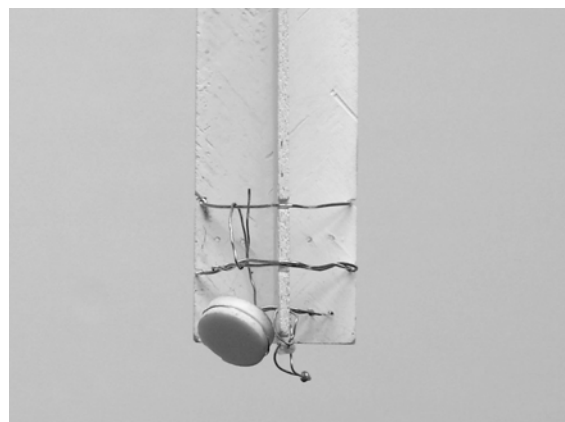
Abbildung 11: Probenhalter des Korrosionsprüfstands mit einer Keramikprobe
