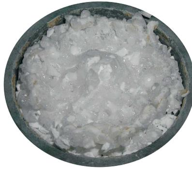
**Abbildung 6.19:** Oberfläche eines  $\text{SiO}_2:\text{Al}_2\text{O}_3$ -Tiegels nach erfolgter Verdampfung (Verschiebung des Mischungsverhältnisses durch fraktionierte Verdampfung).
