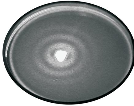
**Abbildung 6.12:** Auswirkung der Mikrostruktur: Interferenzmuster eines lateral in eine  $\text{TiO}_2$ -Schicht eingekoppelten Laserstrahls der Wellenlänge 532 nm.
