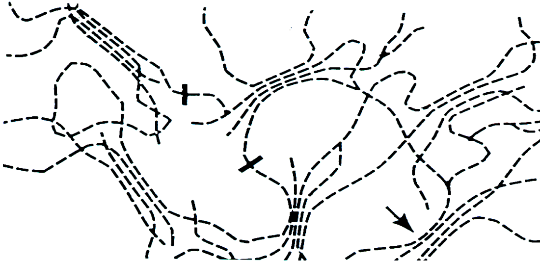
Abbildung 14 : Desintegration (Querstriche) dreidimensionaler Stärkeaggregate mit kristallinen Bereichen (Pfeil) durch die Wirkung von \alpha -Amylasen (Senti, Dimler, S. 28).
