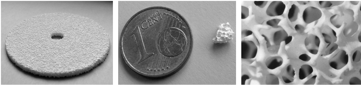
Abbildung 4.30.: Links: Sponceram®-Scheibe für die Bioreaktorkultivierung, Mitte: Sponceram®-Stückchen für Viabilitätstests, rechts: Mikrostruktur (Quelle: www.zellwerk.biz ).
