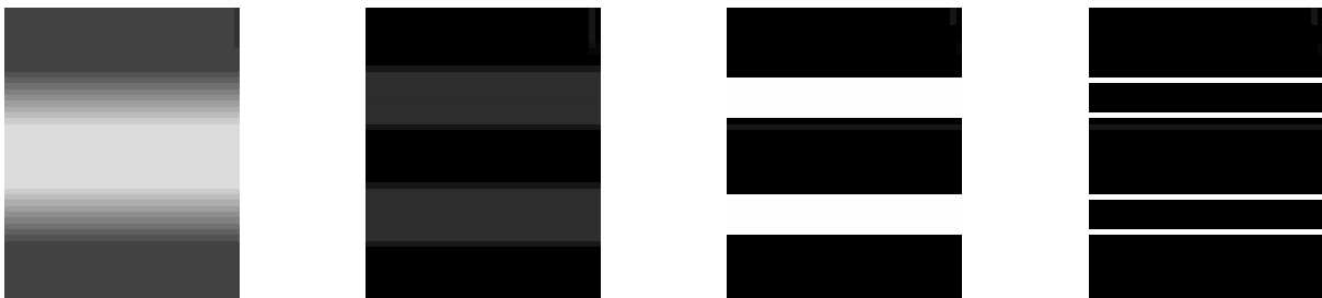
Abbildung 3.3: Ableitung von Bruchkanten an einem Damm mit dem Prewitt Kantenoperator: Höhenraster des Damms (links außen), Neigungsraster durch Anwendung des Prewitt Kantenoperator (links), ebene und geneigte Bereiche (rechts), extrahierte Bruchkanten (rechts außen)
