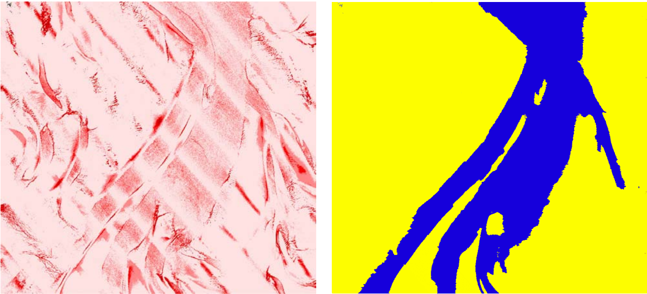
Abbildung 5.31: Befliegung „Außenweser 2005“ – zu klassifizierende Laserpunktwolke intensitätscodiert: hell – geringe Intensität, dunkel – hohe Intensität (links), Ergebnis der Plausibilisierung (rechts): Wasser – blau, Watt – gelb
