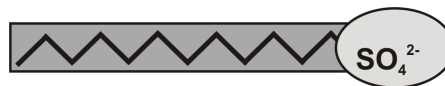
Abbildung 2.17: Charakteristischer Aufbau eines Tensidmoleküls mit hydrophober Kohlenstoffkette und hydrophiler Kopfgruppe am Beispiel von Natriumdodecylsulfat.
