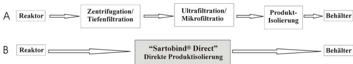
Abbildung 4.4.4: Prozessschema Sartobind ® Direct: (A) herkömmliche Technologie, (B) Einsatz neuer Technologie.
