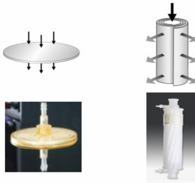
Abbildung 6.1: Prinzip des Membranadsorbermoduls im Labormaßstab (links, Sartobind) und im Technikumsmaßstab (rechts, SingleSep)
