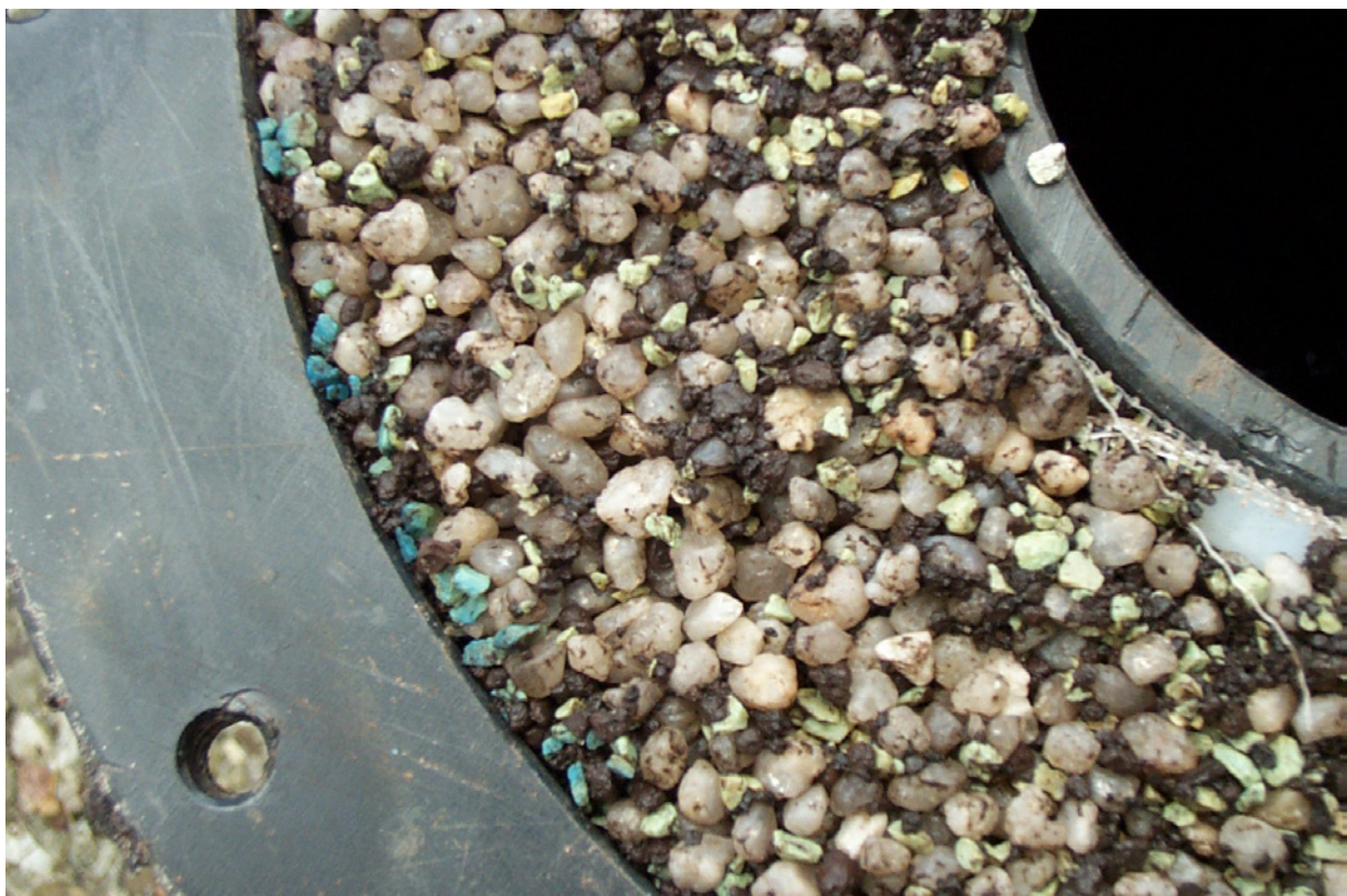
Abb. 160: Fotos vom Filtermaterial nach der Rückspülung (Mischung von Ferrosorp RWR mit Filterkies)
