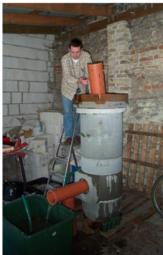
Abb. 59: Versuchsstand für INNOLET®-Filterpatrone
