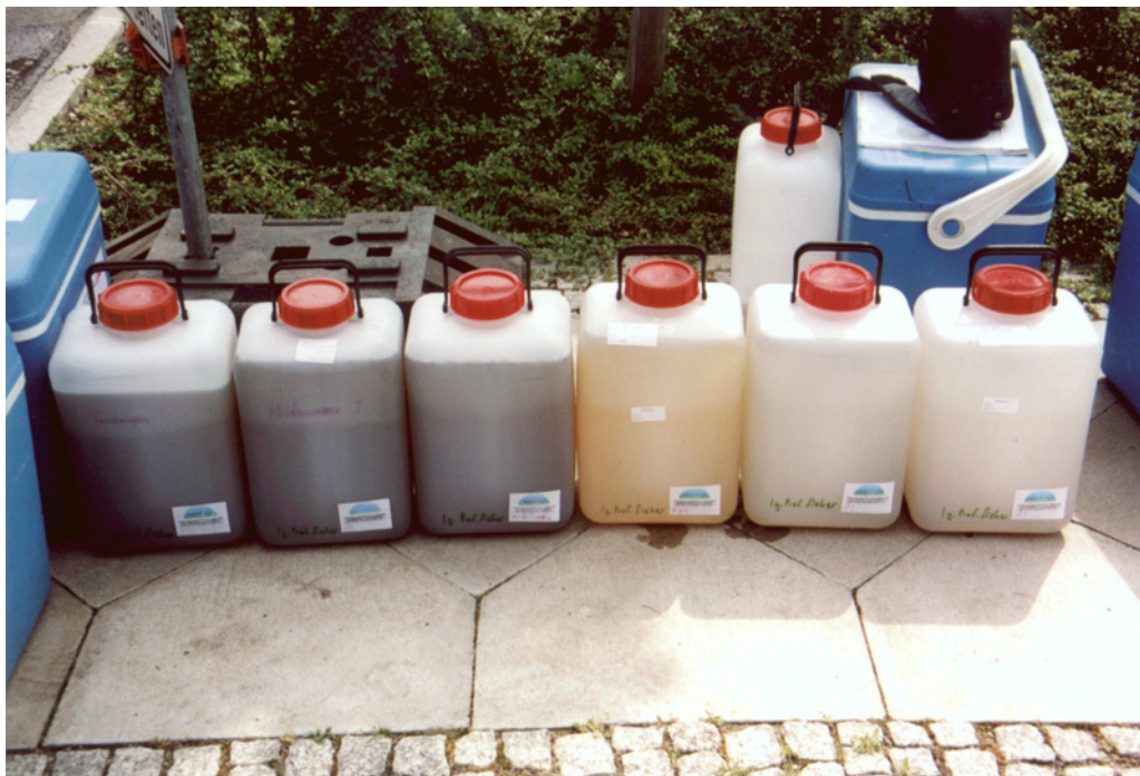
Abb. 115: Kanister mit gesammeltem Probenwasser an verschiedenen Messpunkten beim Flutungsversuch 18.5.2000, von links: Tankwagen, Mischprobe Mulden, Mulde 3, Überlauf 2, Überlauf 3, Ablauf Rigole
