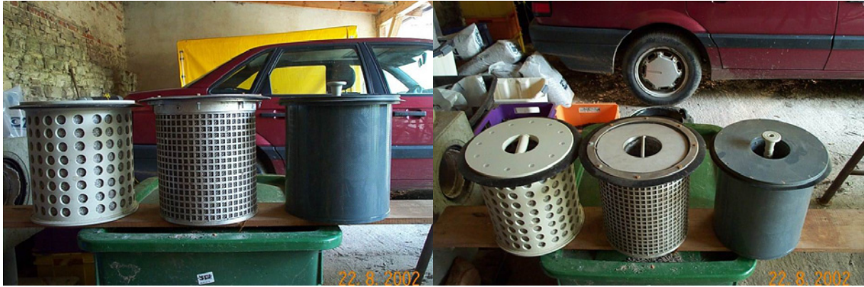
Abb. 62/Abb. 63: Filterkörbe, hergestellte Varianten in PE, Edelstahl und PVC
