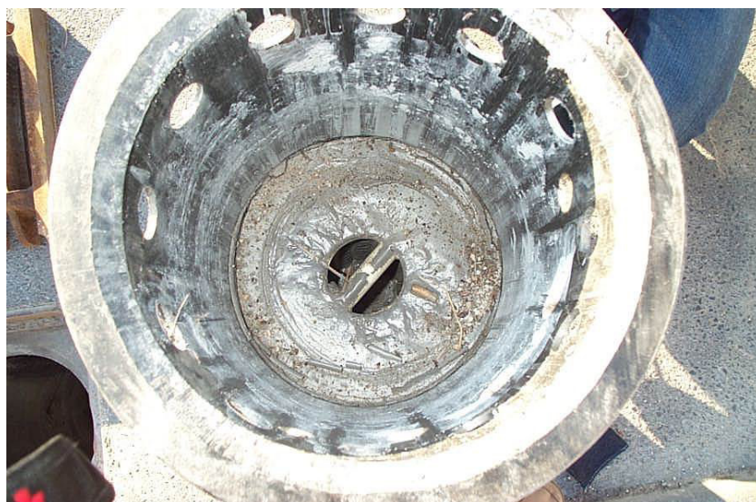
Abb. 86: Beschichtung der Oberfläche des Filtereinsatz in INNOLET®-Filterpatrone mit hartnäckigem Straßenschmutz
