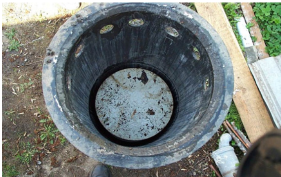
Abb. 97: umgedrehter Filter zur Spülung
