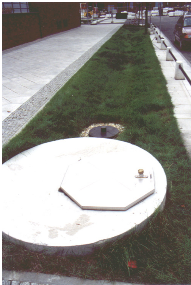
Abb. 42: Versuchsanlage des Mulden-Rigolen-Elementes in Berlin Rummelsburg mit Messschacht (Drosselschacht) für Einbau der Messanlage
