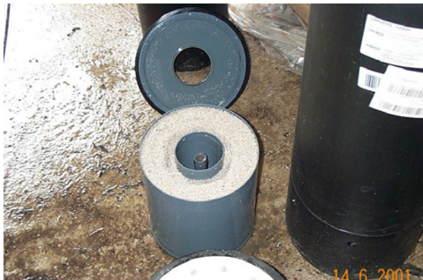
Abb. 80: Filterkorb, geöffnet nach Versuch
