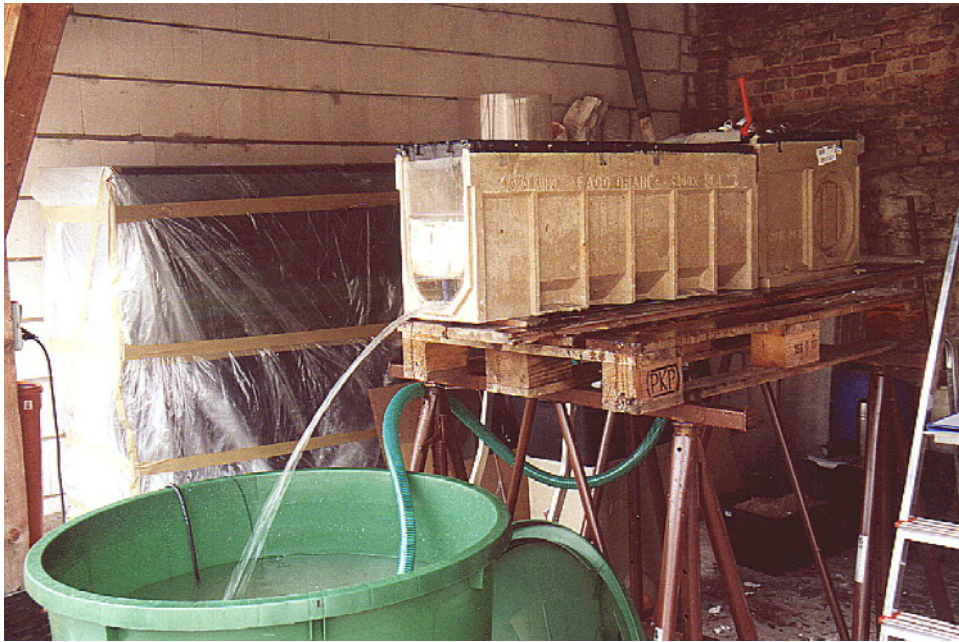
Abb. 76: INNOLET®-Rinne, Versuch zur Bestimmung des hydraulischen Durchsatzes mit eingebautem Filtermaterialeinsatz
