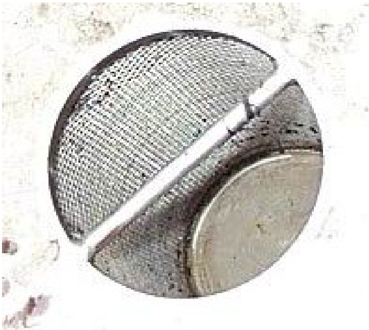
Abb. 108: Nahaufnahme gespülter Edelstahlfilter
