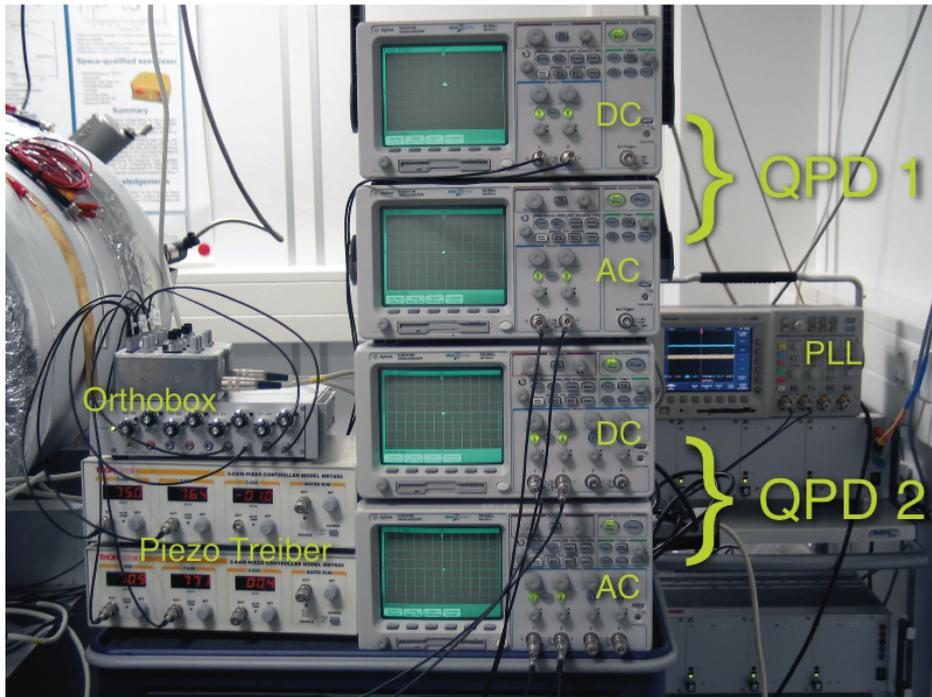
Abbildung 5.13: Messaufbau Strahlfluktuationen.
