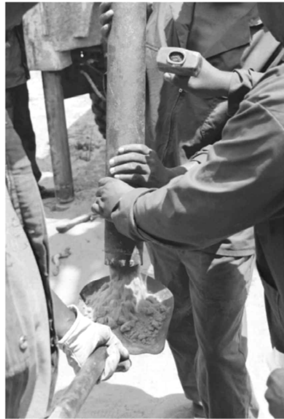
Abb. 4.4 A&B: (A) Hydraulischer betriebener Bohrkopf mit innen liegenden Samplerbohrkern. (B) Entfernen von Bodenmaterial aus dem Sampler, der aus dem Bohrgestänge gezogen wurde. - (A) Hydraulic driven drill head with the core sampler inside; (B) Removal of soil material of the sampler, which has been pulled out of the drill poles.
