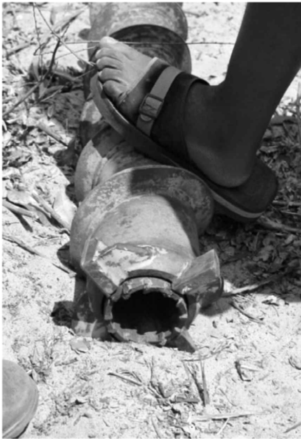
Abb. 4.4 A&B: (A) Hydraulischer betriebener Bohrkopf mit innen liegenden Samplerbohrkern. (B) Entfernen von Bodenmaterial aus dem Sampler, der aus dem Bohrgestänge gezogen wurde. - (A) Hydraulic driven drill head with the core sampler inside; (B) Removal of soil material of the sampler, which has been pulled out of the drill poles.
