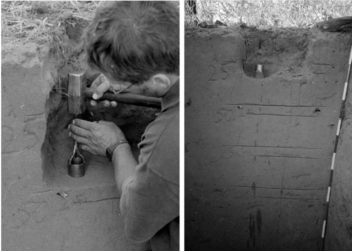
Abb 4.7: Stechzylinder-Beprobung in 25 cm Tiefenschritten zur Bestimmung der ungestörten Lagerungsdichte und pF-Werte (jeweils 2 Wiederholungen). - Sampling of soil in cylinders to determine the undisturbed bulk density as well as pF-values, two repeats in depth steps of 25 cm.
