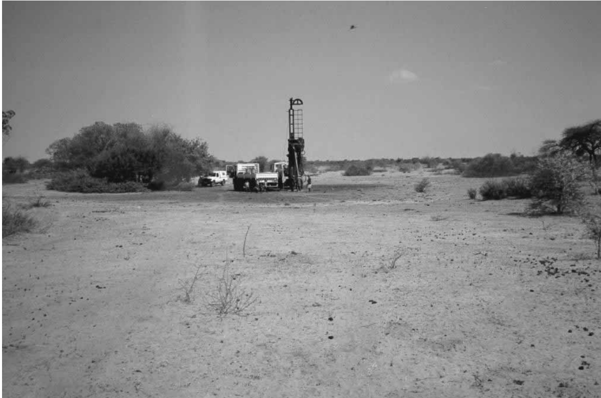
Abb. 5.35: Bodenprofilbohrungen in der Pfanne in der Nähe des Cattle Post Kraales der Serwe Pan Farm. - Soil profile drillings in the pan next to the cattle post kraal of Serwe Pan Farm.
