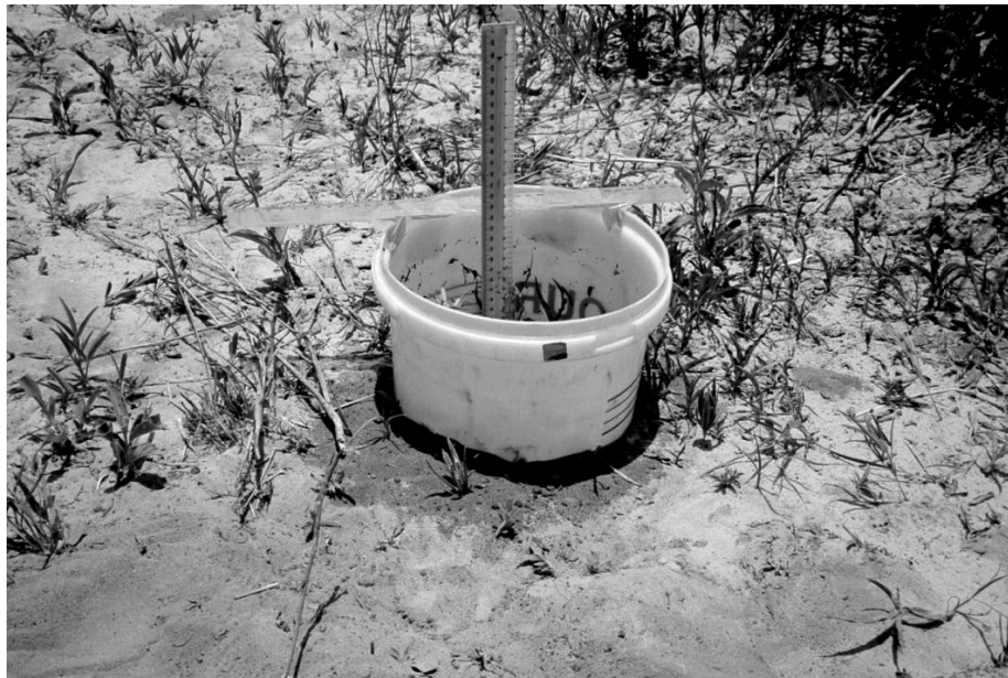
Abb. 5.25: Einfachring-Infiltrometertest auf einem Arenosolstandort. Der absteigende Wasserspiegel wird mit einem Millimeterlineal in Zeitabständen von 30 Sekunden gemessen. - Test by a singlering-infiltrometer at an Arenosol site. The descending water level is measured by a ruler in time intervals of mm in 30 sec.
