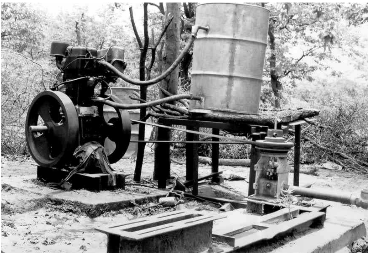
Abb. 3.13: Dieselmotor zum Betrieb einer Brunnen-Tauchpumpe zur Förderung von Grundwasser aus dem Ntane-Sandstone-Aquifer. - Diesel engine powering a submerged well pump, to deliver groundwater from the Ntane sandstone aquifer.
