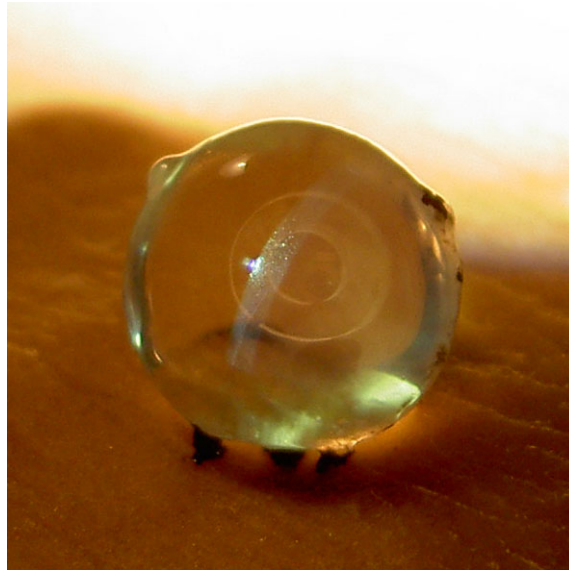
Abbildung 5.14: Zwei zylindrische Schnitte (2 mm und 4 mm) und ein Ringschnitt (2 mm Innendurchmesser bis 4 mm Außendurchmesser) in einer Schweinelinse; d_s = 5 \mu m und E = 620 nJ
