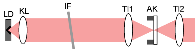
Abbildung 4.11: Schema des Diodenlaser stabilisiert mit Interferenzfilter. LD: Laserdiode, KL: Kollimationslinse, IF: Interferenzfilter, TL1: Linse 1 Katzenaugenteleskop, TL2: Linse 2 Katzenaugenteleskop, AK: Auskoppler mit teildurchlässigem Spiegel auf Piezohalterung.
