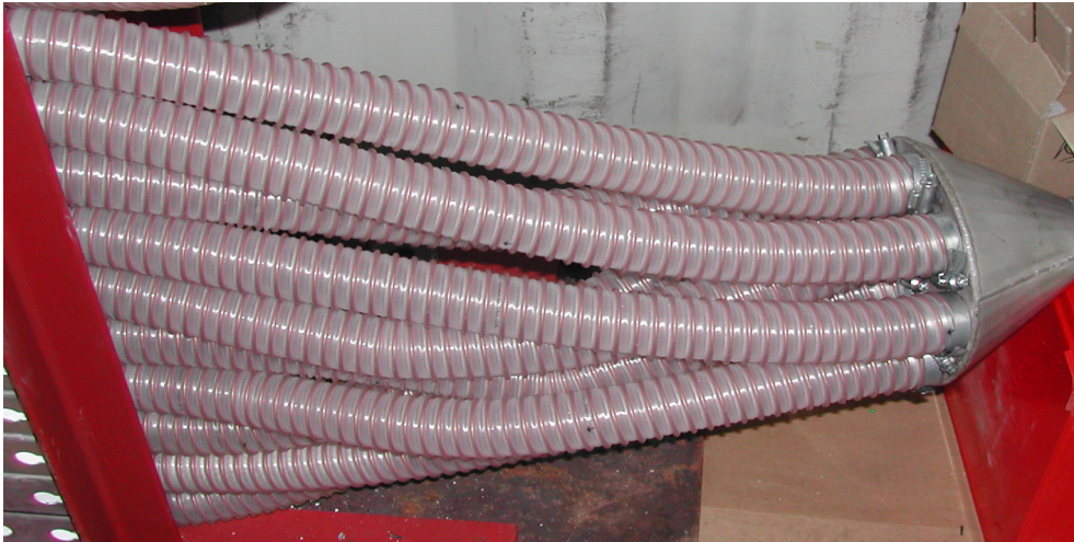
Foto 2: Teilung des Volumenstroms auf die einzelnen Untereinheiten
