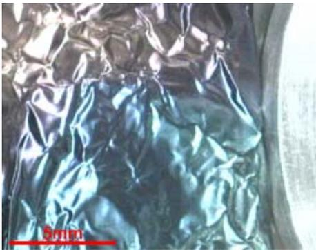
**Abb. 3-19:** Videobild der in der Pumpe angebrachten Folie. Erkennbar ist eine bläuliche Verfärbung im unteren Bereich.
