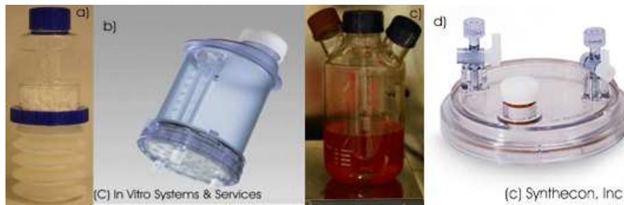
Abbildung 3.1: Kultivierungssysteme für CHO hGH: a) BelloCell, b) miniPERM, c) Spinnerflasche, d) RCCS
