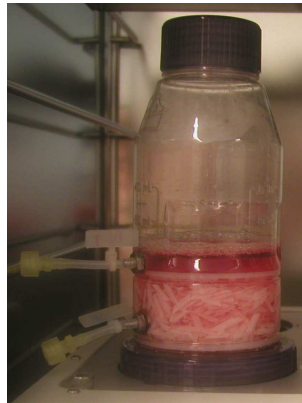
Abbildung 4.10: Lage der Luer-Lock-Anschlüsse am BelloCell für den Perfuptionsbetrieb
