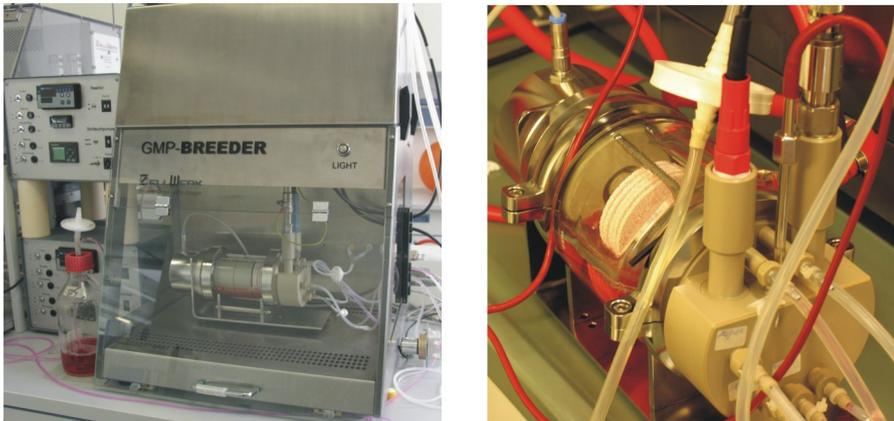
**Abb. 4.7:** BIostat® Bplus RBS 500 im GMP-Breeder (links) und mit Doppelmantelgefäß (rechts).
