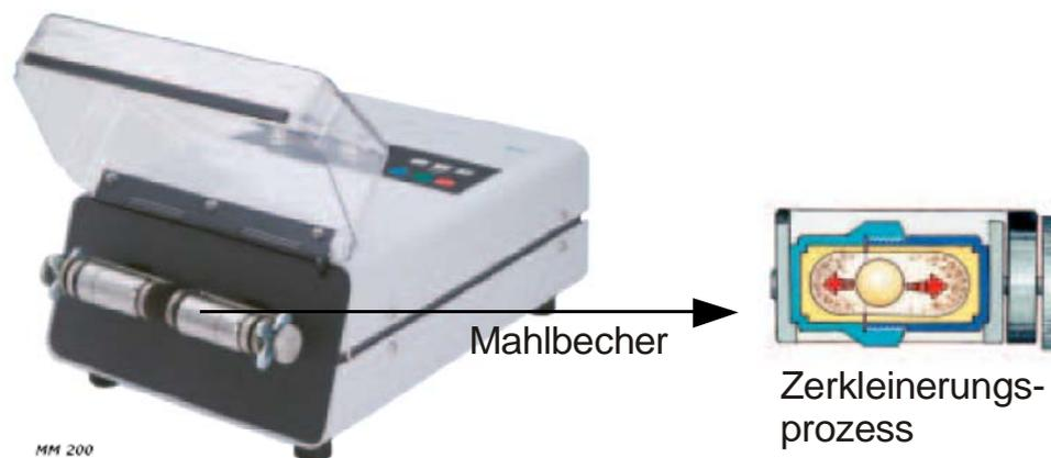
**Abbildung 3.01:** Schwingmühle (Mahltechnik: s. Anhang 14.7) [97]
