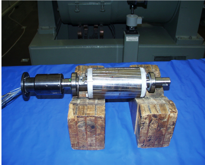
Bild 4.4: Mit Thermoelementen präparierter Rotor
