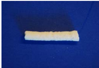
Abbildung 11-1: Foto eines getrockneten Chitosan-Aluminiumhydroxid-Komposites mit einem Massenverhältnis von 40/60 m-% Chitosan/Aluminiumhydroxid.
