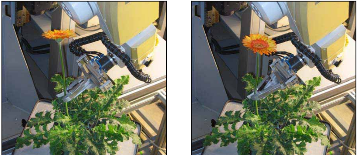
Abbildung 7.21: Beispiel für eine Ernteposition, bei der keine weitere Stielverfolgung möglich war (links) und der Schnitt deshalb direkt nach Anfahrt des Blütenstiels durchgeführt wurde (rechts).
