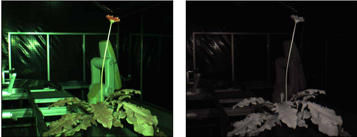
Abbildung 5.9: Vergleich der Aufnahmen ohne (links) und mit Infrarotfilter (rechts).
