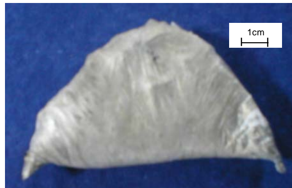
Bild 7.6: Nach 30 min. entnommene AZ91-Probe (Ar-Atmosphäre).
