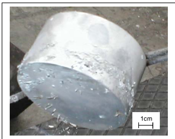
Bild 5.2.10: BN-Schwimmkörper nach 1 Stunde in der Schmelze.
