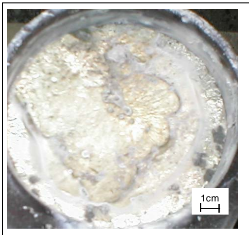
Bild 5.1.17: Schmelzbadoberfläche nach 30 min. bei ca. 700 °C.
