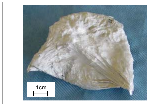
Bild 7.9: Nach 30 min. entnommene AZ91-Probe bei der Abdeckung mit CO 2 -Schnee.
