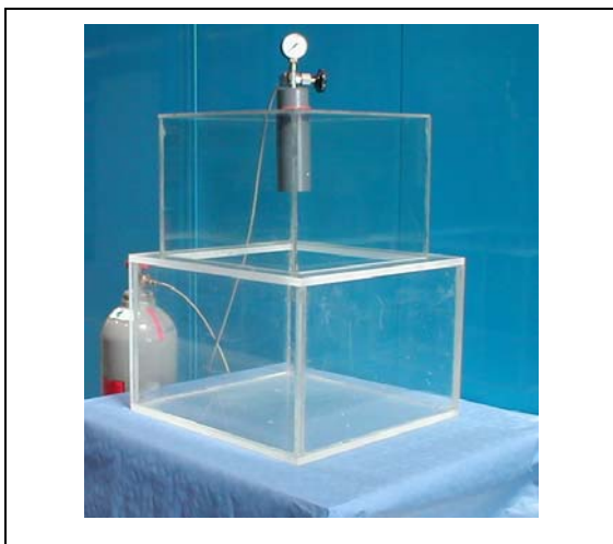
Bild 5.5.10: Plexiglasmodell des Ofentiegels.
