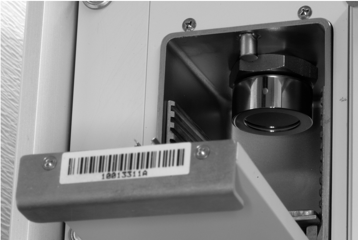
Abb. 43: Halbleiterdetektor ( Canberra Model A300-17AM Alpha PIPS Detector ) im eingebauten Zustand. Die kreisförmige strahlungsempfindliche Fläche ( 300 \text{ mm}^2 ) ist sichtbar.
