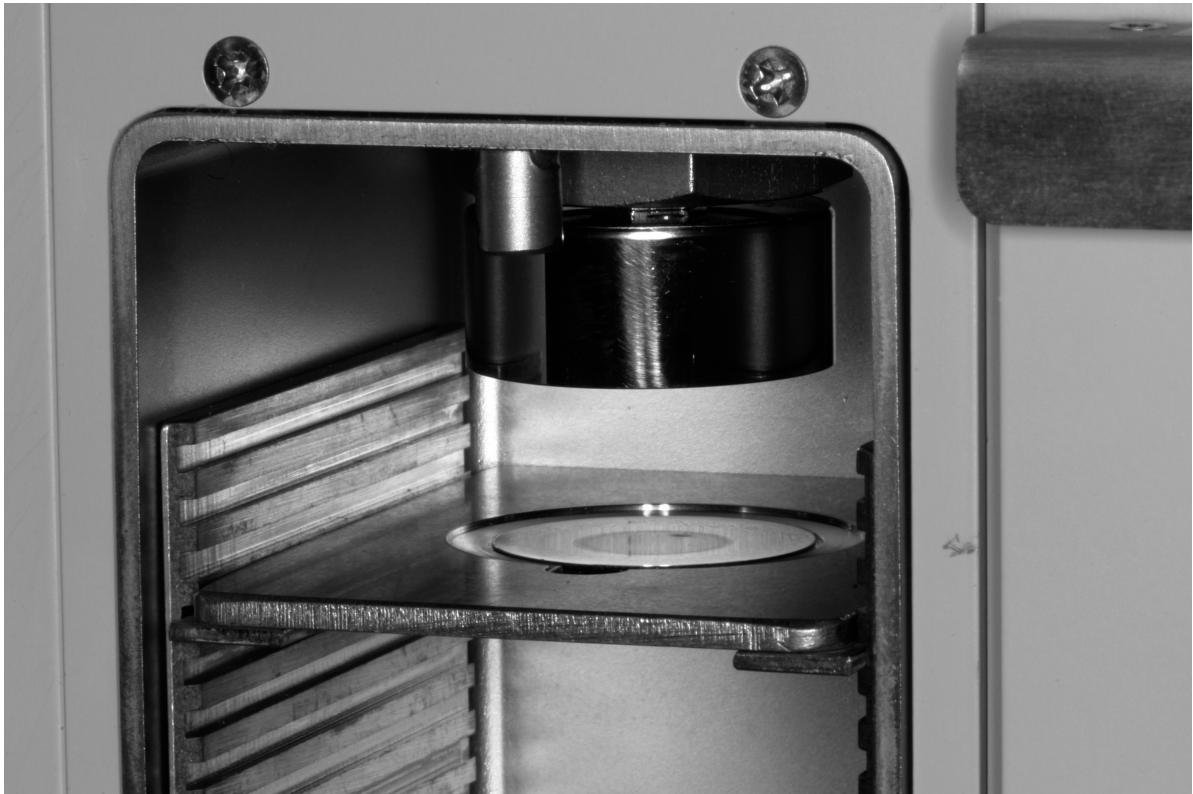
Abb. 45: Schrägansicht einer \alpha -Messkammer zur Verdeutlichung der coaxialen Anordnung des PIPS-Detektors über dem kreisförmigen Messpräparat
