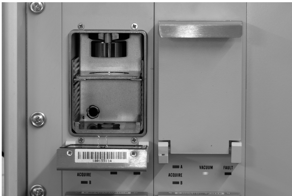
Abb. 42: Eine geöffnete \alpha -Messkammer neben einer geschlossenen. Im oberen Teil der Kammer ist der Halbleiterdetektor zu erkennen; darunter befindet sich der höhenverstellbare Probenhalter mit einem Messpräparat. Die Öffnung unten links an der Rückwand dient zum Evakuieren oder Belüften der Kammer.
