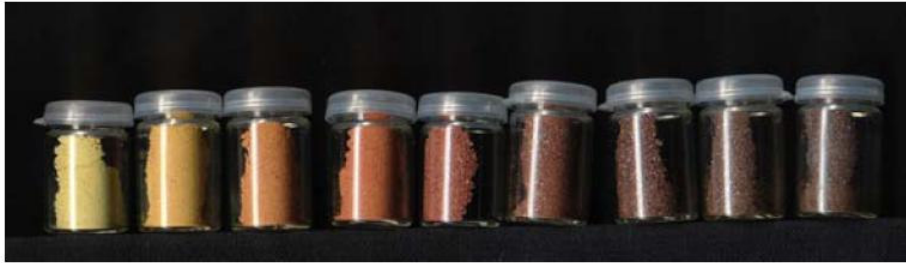
Abb. 2-2 Farben von gemörserten \text{ZnS}_x\text{Se}_{1-x} -Kristallen von hellgelben ZnS (links) bis tiefweinrotem ZnSe (rechts) [11]
