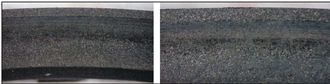
Abb. 7-4: Dichtring mit geglätteter Laufspur im Bereich nahe der Wellenaußenkante
