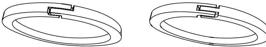
Abb. 5-25: Typische Stoßformen für REDR aus thermoplastischen Kunststoffen links: 2-L-Stoß, rechts: 2-T-Stoß
