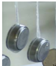
Abbildung 31: Die Datenlogger für die Haut- und die Körperkerntemperaturmessung wurden während der Trocknung des Silikons am Polyesterfaden aufgehängt.
