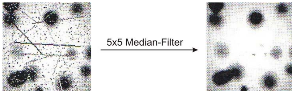
Abb. 2.1.2.: Anwendung eines 5x5 Median Filters auf ein digitales Bild; links: starkes Bildrauschen; rechts: Ergebnis nach Medianfilterung. Bilderquelle: [Voss et al., 1991]
