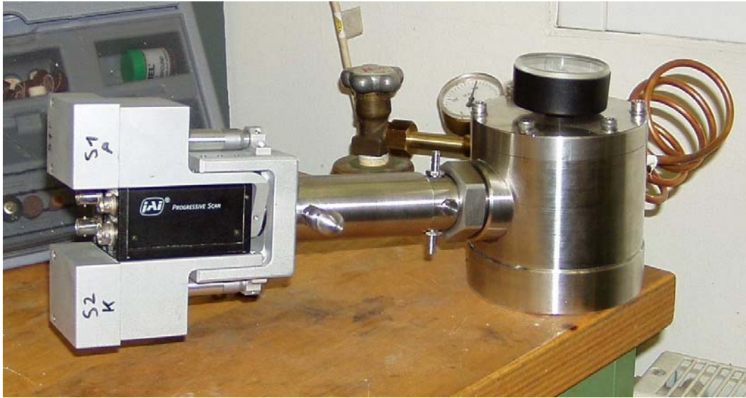
Abb.: 11.4.1.: ISM-Typ PM1 integriert in eine Druckzelle mit angeschlossener Stickstoffgasflasche und Flaschendruckminderer [Rudolph, 2004]
