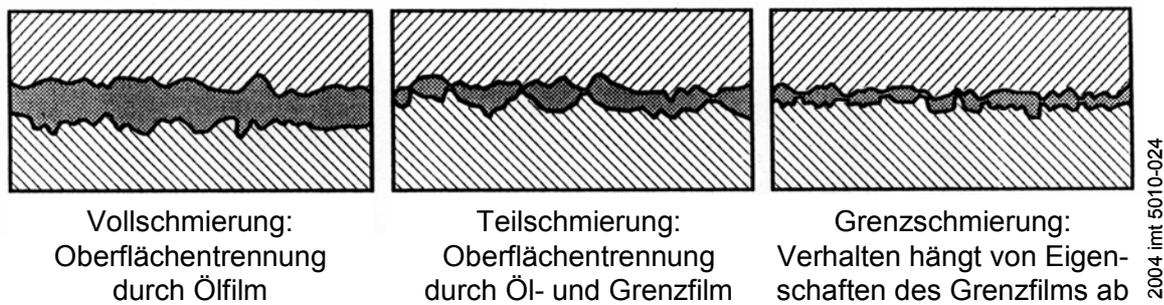
Abbildung 2.24: Schmierzustände im Wälzkontakt [FRA99b]
