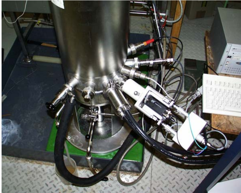
Abb.18: Detailansicht der Laboranlage mit dem Insitu-Mikroskop
