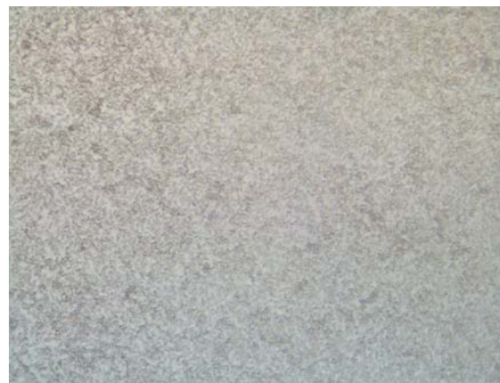
Abb. 45: Probe nach HDH-Aufschluss - keine intakte Zellen sichtbar (400 X Vergr.)
