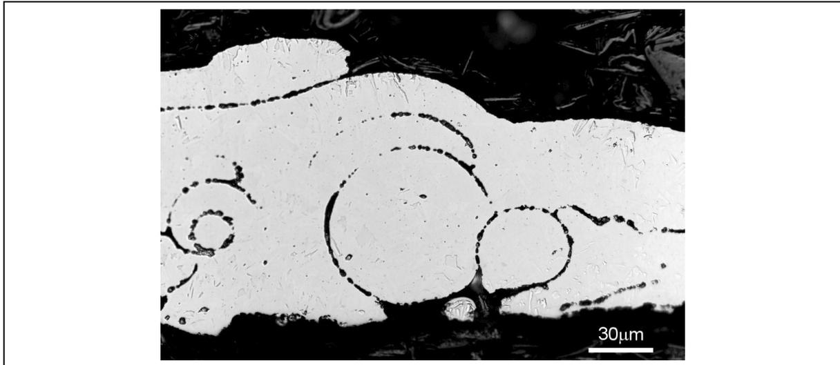
**Bild 6-24:** Erste Stufe der Schichtbildung; Koagulierende Ti-Partikel; Ätzung: 100 ml H<sub>2</sub>O + 5 ml 37%ige HNO<sub>3</sub> + 3 ml 39%ige Flusssäure; nach dem Ätzen erneut poliert
