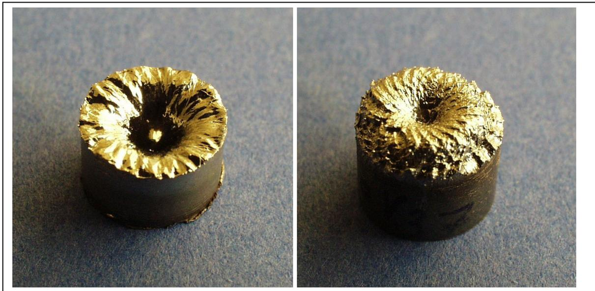
**Bild 6-13:** Erschmolzene Stabstirnseiten bei  $18.000 \text{ min}^{-1}$  (links) und  $35.000 \text{ min}^{-1}$  (rechts); Mo,  $\varnothing = 10 \text{ mm}$ ,  $I_B = 78 \text{ mA}$
