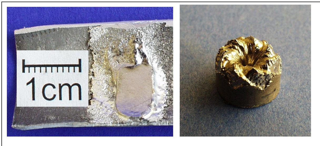
**Bild 6-26:** Ti-Schicht auf Al-Substrat und Stirnseite des abgeschmolzenen Ti-Stabes mit  $\varnothing = 10 \text{ mm}$ ;  $I_B = 0,050 \text{ A}$ ,  $30.000 \text{ min}^{-1}$
