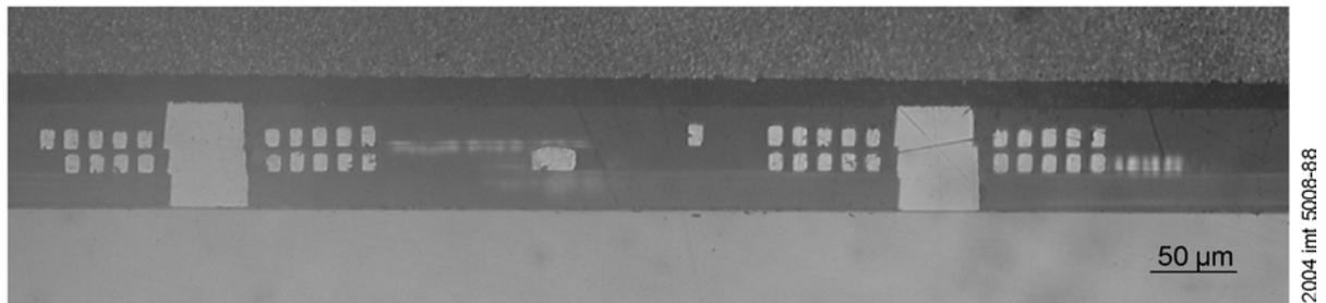
**Bild 8-7:** Schliffbild durch komplettes Spulensystem
