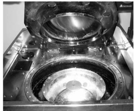
**Bild 5-3:** Lackschleuder mit rotierendem Deckel für hohe Photolackdicken
