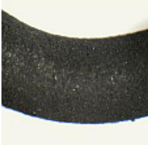
**Abbildung 7.1.34:** Silicidschicht auf Wolframdraht
