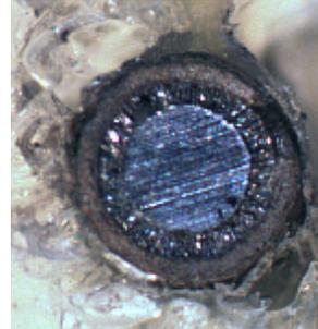
**Abbildung 7.2.26:** Querschnitt des Borid-beschichteten Vanadiumdrahtes
