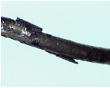
Abbildung 7.3.14: Carbidschicht auf Tantaldraht
