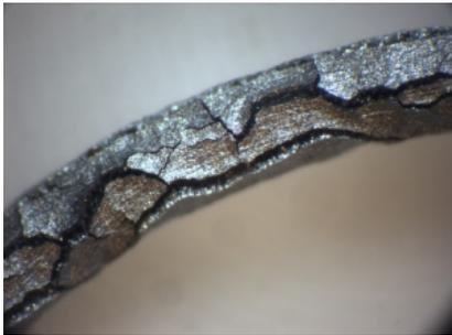
**Abbildung 7.1.7:** Silicidschicht auf Molybdändraht
