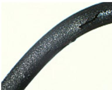
**Abbildung 7.3.4:** Carbidschicht auf Molybdändraht
