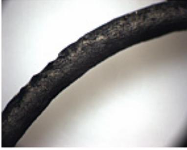
Abbildung 7.1.24: Silicidschicht auf Titandraht
