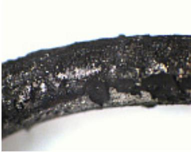
Abbildung 7.3.9: Carbidschicht auf Niobdraht
