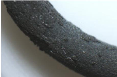
Abbildung 7.1.39: Silicidschicht auf Zirkoniumdraht
