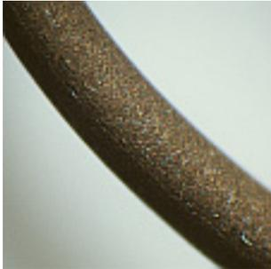
Abbildung 7.1.19: Silicidschicht auf Tantaldraht
