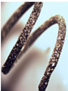
Abbildung 7.2.10: Boridschicht auf Niobdraht
