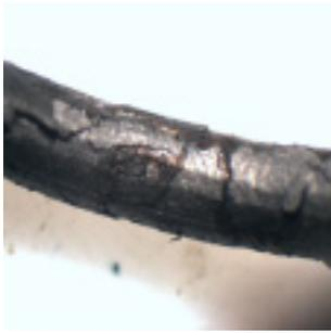
Abbildung 7.3.29: Carbidsschicht auf Wolframdraht
