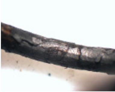
Abbildung 7.3.24: Carbid-schicht auf Vanadiumdraht
