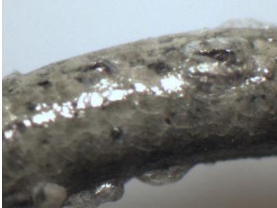
Abbildung 7.1.29: Silicidschicht auf Vanadiumdraht
