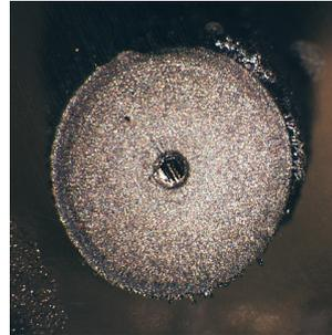
Abbildung 7.1.40: Querschnitt des silicierten Zirkoniumdrahtes
