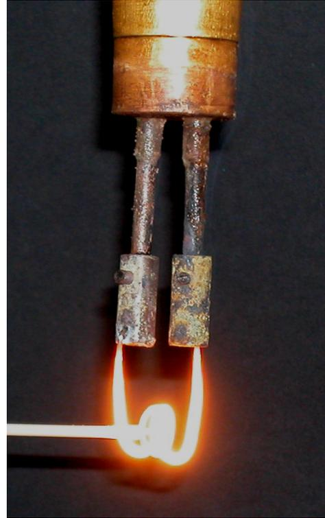
**Abbildung 8.4:** Erhitzen von MoSi<sub>2</sub>-beschichtetem Draht
