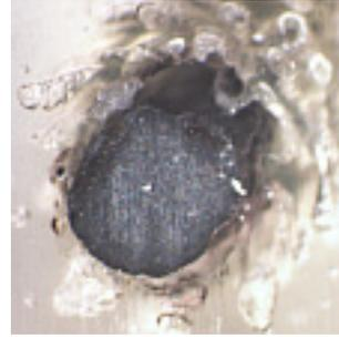
Abbildung 7.3.25: Querschnitt des Carbid-beschichteten Vanadiumdrahtes
