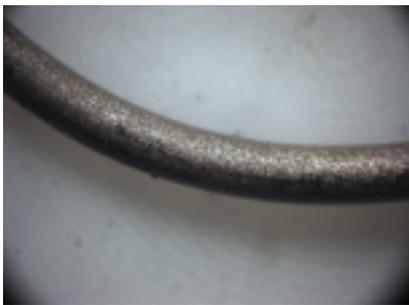
**Abbildung 7.1.14:** Silicidschicht auf Niobdraht
