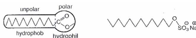
**Abbildung 5-11:** Schema polar/unpolar am Beispiel von SDS (Natriumdodecylsulfat) [100]
