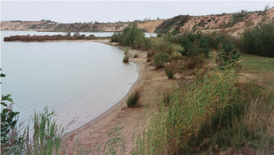
Abb. 35: Ausbildung der Wasserwechselzone im Sand mit einer Neigung von H:L ~ 1:8,00 an einem Baggersee in glazifluviatilen Ablagerungen der Saale-Kaltzeit (Drenthe-Stadium) (*Aufschluss-Nr.*: 42, Niedersachsen).
