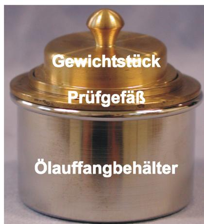
**Bild 39:** Prüfgerät zur Bestimmung der statischen Ölabscheidung
