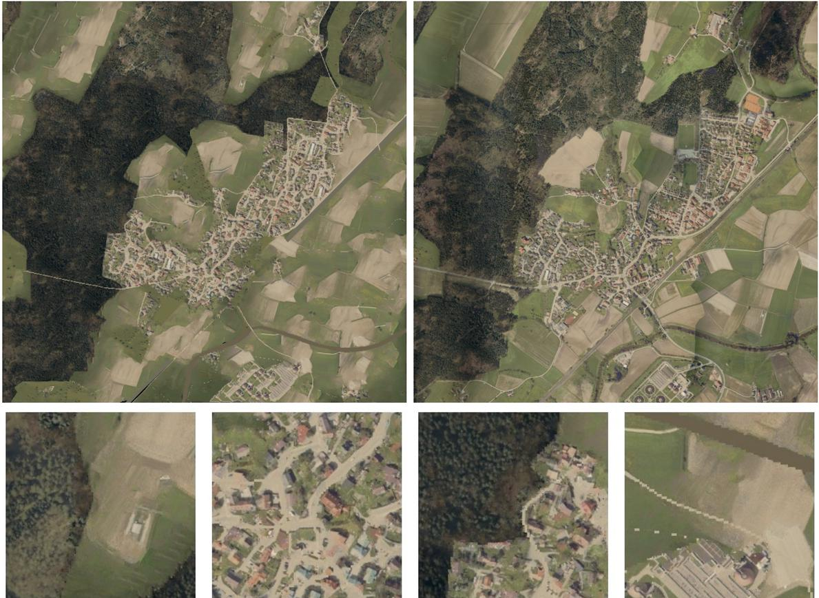
Abbildung 5.5: Synthetisches Luftbild (links oben) mit vier Ausschnittsvergrößerungen (untere Reihe) und Orthophoto (rechts oben).
